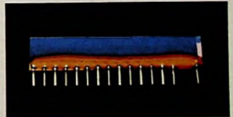
Dickschicht-Schaltung. Originalgröße 15 x 40 mm.
