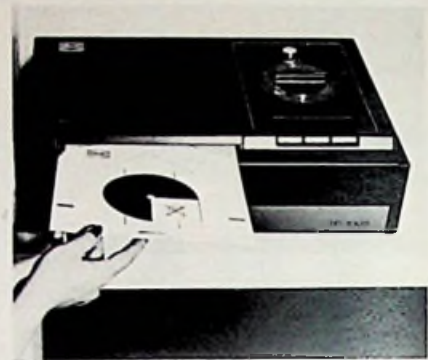
So einfach ist die Handhabung des TED-Bildplattenspielers: Die Platte mitsamt Innentasche wird der Außentasche entnommen und in den Einlegeschlitz geführt. Alles andere bis zur Rückgabe der Bildplatte in Ihrer Innentasche erledigt die Automatik
