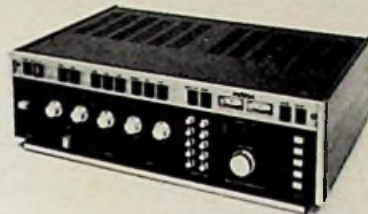
Bild 1. Digital-FM-Tuner-Vorverstärker „Revox A 720“ von Studer
